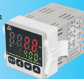
Encendido y apagado controlador electrónico de doble pantalla de 48 x 48 mm y PID autoajuste, sensores múltiples, salidas de relé y SSR
